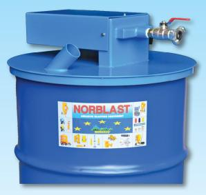
**NOB5300** - Système d'aspiration pneumatique pour fût de 200L développé pour l'aspiration de petites quantités d'abrasif ou de poussières. L'aspiration est générée par le jumelage de deux venturi alimentés par de l'air comprimé. Aucun raccordement électrique n'est requis. Disponible en système complet avec le fût de 200L fourni ou en système nu sans le fût.
