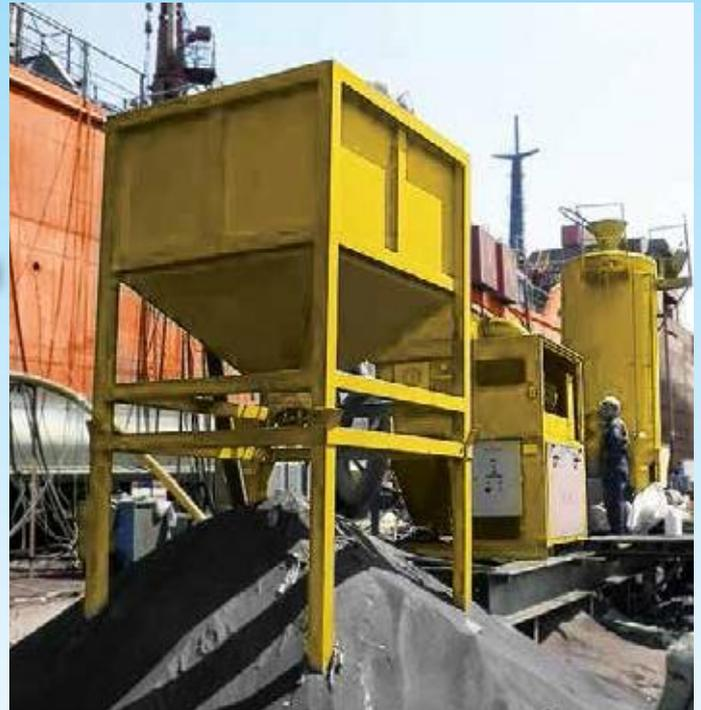
**Les systèmes d'aspiration série VR par NOREXCO®** ont été développés pour répondre aux besoins des applicateurs, afin de retirer l'abrasif utilisé des sites après sablage.
